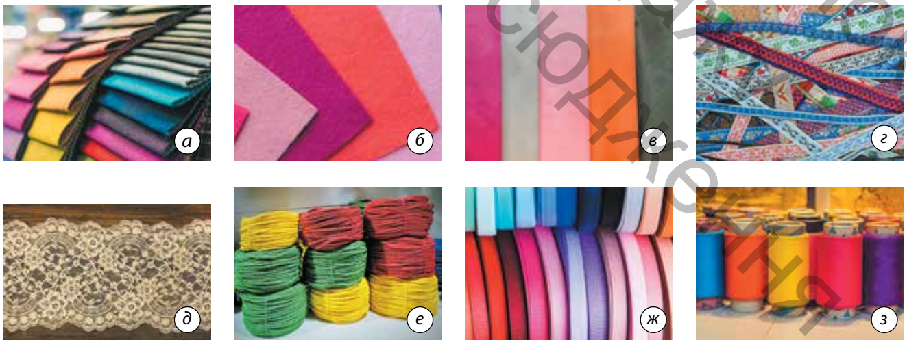
Мал. 6.3. Текстильні матеріали: а — тканини; б — фетр; в — флізелін; з — тасьма; д — мереживо; е — шнури; ж — атласні стрічки; з — нитки
