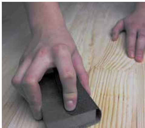
Мал. 9.14. Закріплення наждачного паперу на бруську
