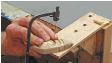
Мал. 4.5. Виготовлення деталей способом випилювання за допомогою різних інструментів
