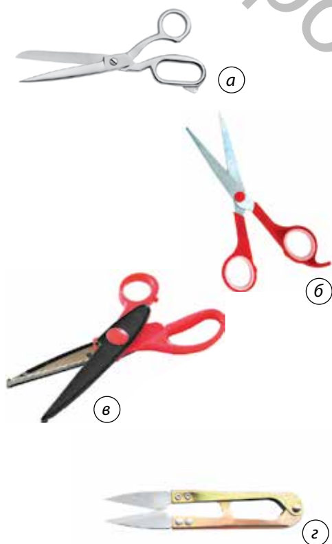
Мал. 10.5. Ножиці: a — кравецькі; б — для паперу; в — із зубчастими лезами; г — для обрізування ниток
