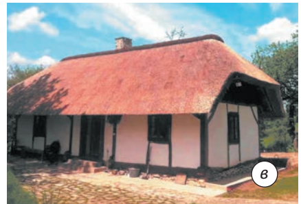
Мал. 1.3. Використання природних матеріалів у будівництві екологічного житла: а — солom'яний блок; б — стіновий каркас із соломи; в — дах з очерету
