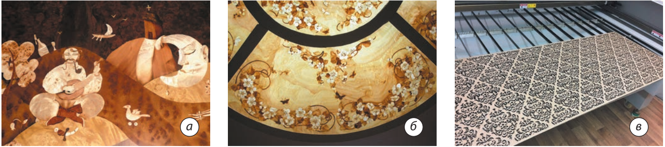
Мал. 1.8. а — маркетрі на деревині; б — маркетрі на склі; в — випилювання ажурних візерунків зі шпону лазером
