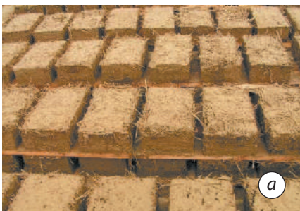
Мал. 1.4. а — саман; б — зовнішній вигляд будинку із саману; в — внутрішні поверхні оброблені глиною
