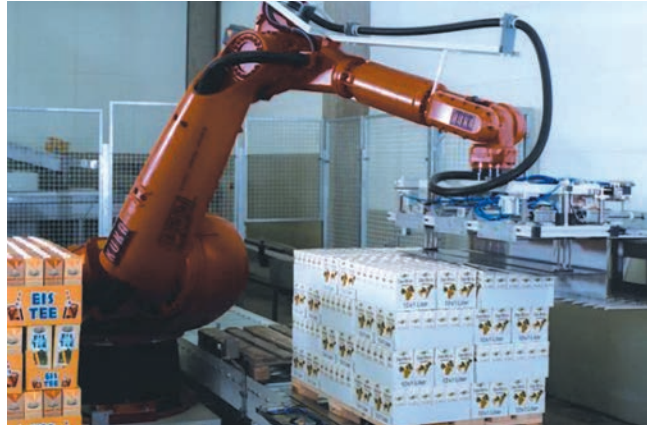
Мал. 10.4. Схема автоматичної лінії із застосуванням робота
