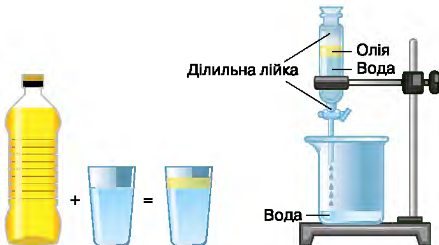
Мал. 32. Спосіб розділення суміші води й олії за допомогою ділильної лійки
