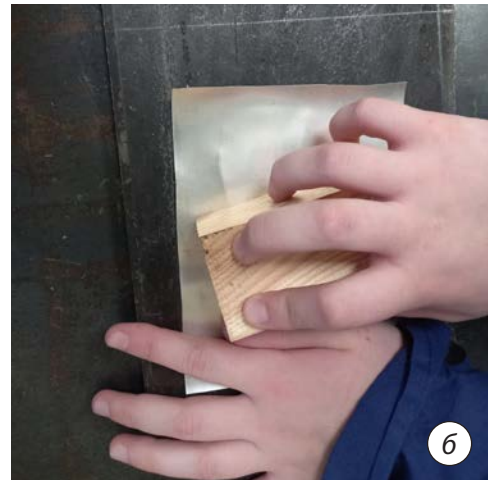
Мал. 15.4. Різні процеси вирівнювання: а — за допомогою киянки; б — за допомогою дерев'яного бруска правилки
