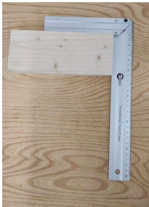
Мал. 18.9. Контроль показників за допомогою столярного кутника
