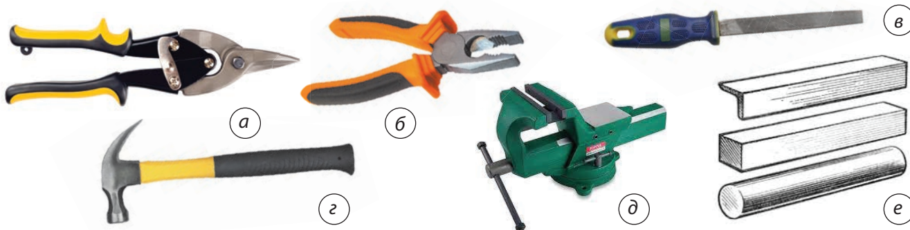
Мал. 15.3. Інструменти та пристосування, необхідні для виготовлення виробів із тонколистового металу : а — ножиці по металу; б — плоскогубці; в — напилек із мілкою насічкою; г — молоток; д — слюсарні лецата; е — оправка
