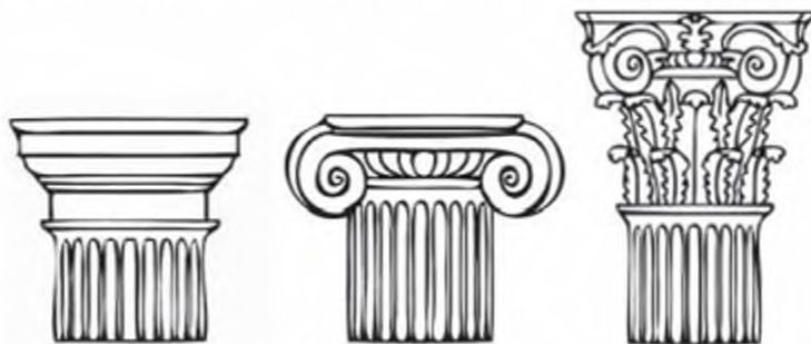
Капітелі колон доричного, іонічного та коринфського ордерів
