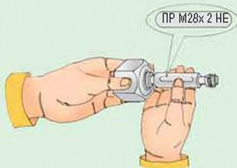
Мал. 165. Перевірка якості внутрішньої різьби в умовах виробництва спеціальними різьбовими калібрами
