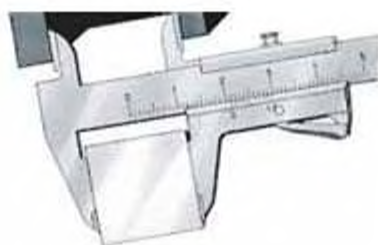
Мал. 127. Приклад використання штангенциркуля для перевірки паралельності та взаємної перпендикулярності сторін деталі
