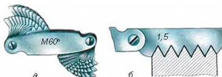
Мал. 166. Різьбовий щуп-шаблон (а) і вимірювання ним кроку різьби (б)
