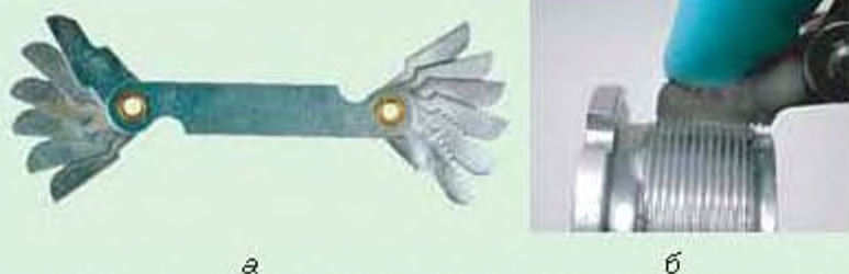
Мал. 164. Різьбовий щуп (а) і спосіб його використання (б)
