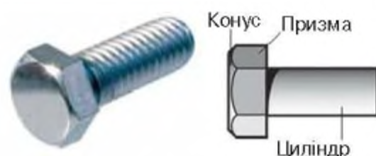
Мал. 67. Геометрична будова болта
