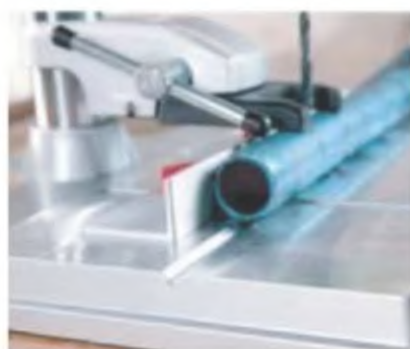
Мал. 143. Використання призматичної підставки для жорсткої фіксації виробу
