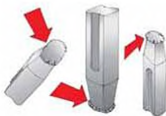
Мал. 107. Форма бойка, яка зазнала значної деформації (розклепування) від ударів молотком
