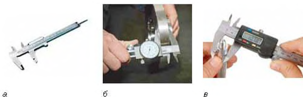
Мал. 55. Штангенциркулі: а — ноніусний; б — циферблатний; в — цифровий
