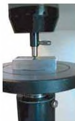
Мал. 28. Вимірювання твердості металу за методом Роквелла
