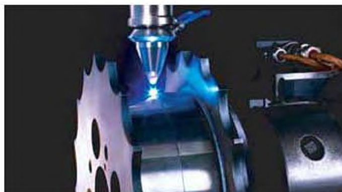
Мал. 171. Лазерне зварювання вала-шестерні
