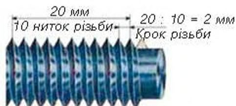
Мал. 146. Вимірювання та обчислення кроку різьби
