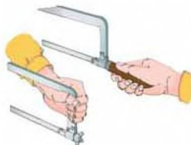
Мал. 94. Положення рук під час роботи з ножівкою
