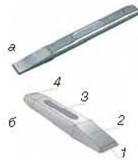
Мал. 106. Зовнішній вигляд слюсарного зубила (а) та будова слюсарного зубила (б): 1 — різальна крайка; 2 — робоча частина; 3 — стрижень (руків'я); 4 — головка (бойок)
