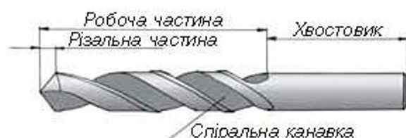
Мал. 136. Основні частини спірального свердла
