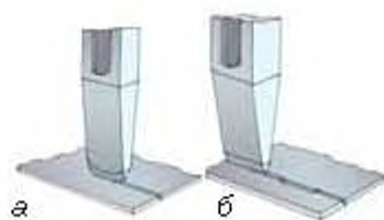
Мал. 117. Вплив форми леза зубила на якість отриманої канавки
