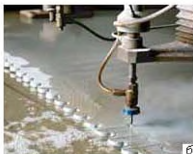
Мал. 89: а — деталі з металу в повсякденному житті й на виробництві; б — різання водою (гідроабразивне різання)
