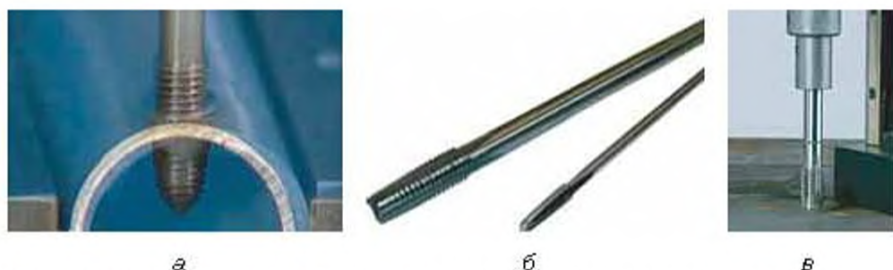
Мал. 157. Нарізування різьби машинним мітчиком (а), конструкції машинних мітчиків (б) і пристосування до нарізування різьби машинним мітчиком на свердильному верстаті (в)
