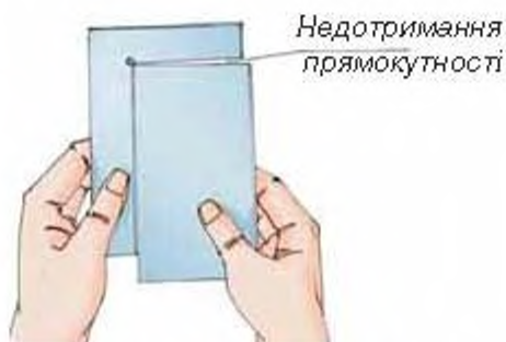
Мал. 125. Контроль зовнішнього кута деталі за допомогою кутника
