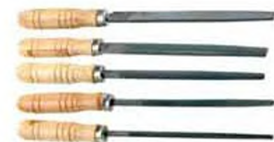
Мал. 20. Інструменти, що виготовляють з інструментальних вуглецевих сталей: а — молотки та зубила; б — напилки
