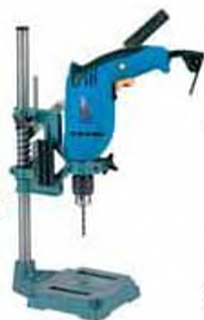
Мал. 180. Стояк для дриля — додаткове приспособлення для роботи
