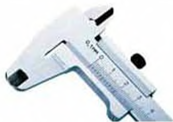
Мал. 62, а. Нульові позначки ноніуса і штанги збігаються
