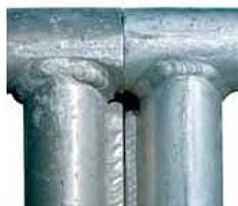
Мал. 5. Якість зварювального шва залежить від виду зварюваних сталей
