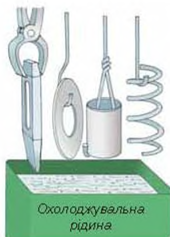
Мал. 32. Приклади правильного занурення деталей в охолоджувальну рідину для загартування
