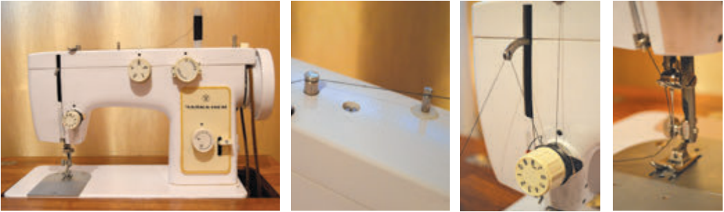
Мал. 7.1. Послідовність заправлення верхньої нитки в швейній машині
