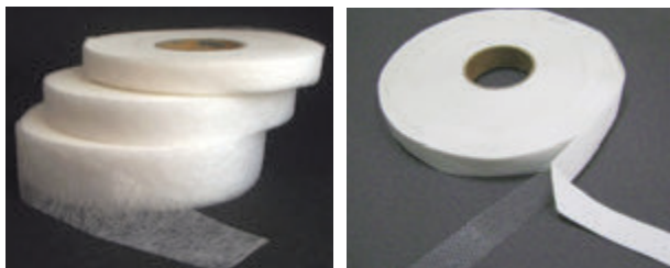
Мал. 12.5. Клейові матеріали для підгину низу: а — клейова павутинка; б — сітка для термічного склеювання
