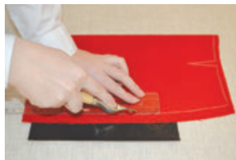
Мал. 8.3. Перенесення ліній викрійки за допомогою копіювального паперу
