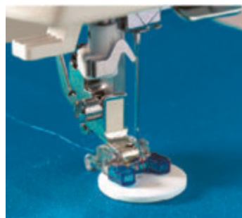
Мал. 13.6. Пришивання ґудзиків на швейній машині
