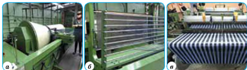
Мал. 17. Навивання основи на снувальний вал (а) та процес ткання (б, в)
