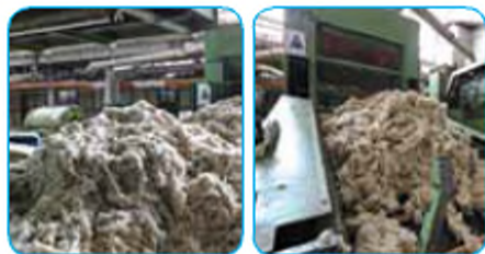
Мал. 12. Вовна на розрихлювально-очисній машині після миття
