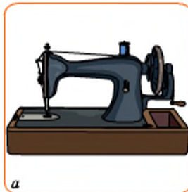
Мал. 150. Швейні машини: а — з ручним приводом, б — з ножним приводом, в — з електричним приводом
