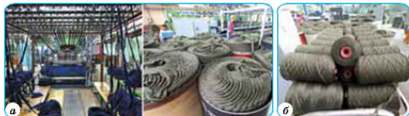
Мал. 15. Робота на рівничній машині (а) та готова до прядіння рівниця (б)
