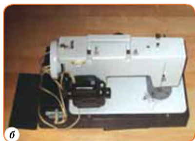
Мал. 155. Швейні машини з електричним приводом: а — вбудованим; б — навісним
