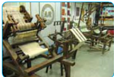
Мал. 25. Ручний верстат для ткання шовкової тканини
