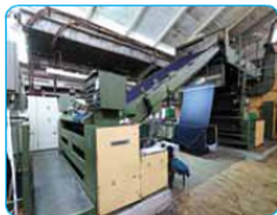
Мал. 18. Декатирування та сушіння тканини
