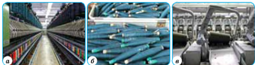
Мал. 16. Прядіння на прядильних машинах (а); намотана на шпулі пряжа (б); перемотування пряжі на бобіни (в)
