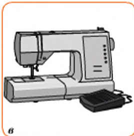
Мал. 150. Швейні машини: а — з ручним приводом, б — з ножним приводом, в — з електричним приводом
